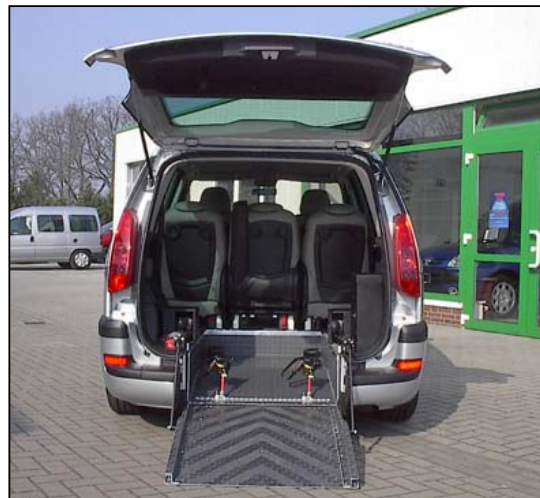
Fahrzeug einfahrbereit abgesenkt
