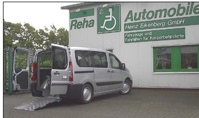
Fahrzeug einfahrbereit abgesenkt
