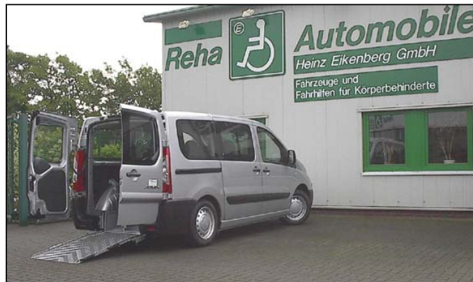
Fahrzeug einfahrbereit abgesenkt
