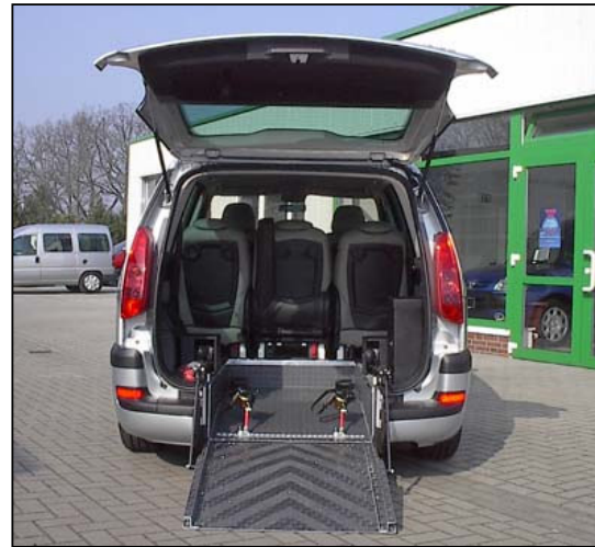
Fahrzeug einfahrbereit abgesenkt
