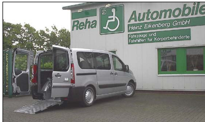
Fahrzeug einfahrbereit abgesenkt
